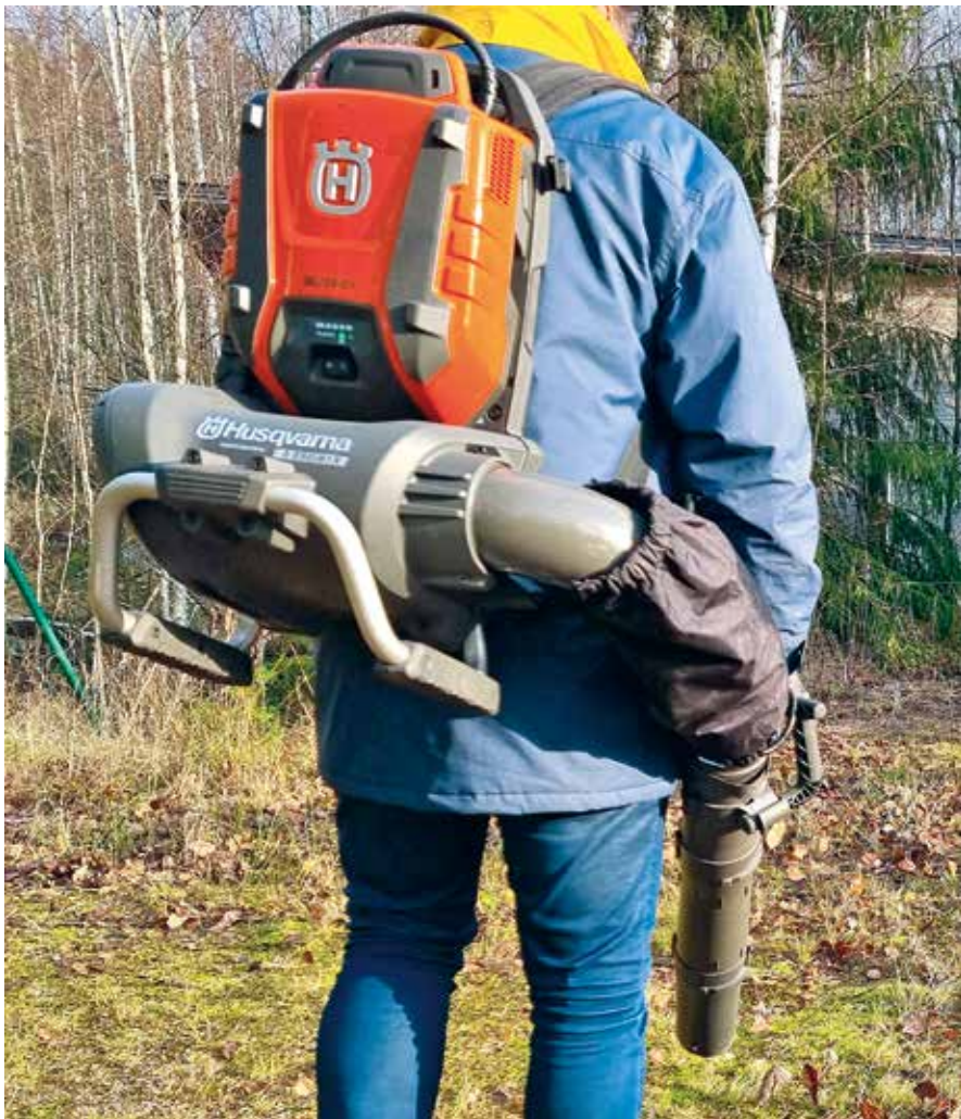
Tarjolla on myös suurempia ammattilaitteita, joissa sekä iso akku että puhallinmoottori on puhaltajan selässä. Näissä laitteissa saadaan huomioitua paremmin työergonomia ja pitkät käyttöajat.
