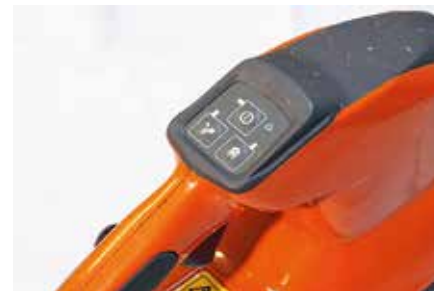
Ylimmästä napista puhallin käynnistyy. Vasen nappi alhaalla lukitsee puhalluksen, jotta liipaisinta ei tarvitse painaa jatkuvasti. Oikea nappi alhaalla käynnistää turbopuhalluksen.
