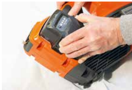
Akku irttoa painamalla akun sivuilla sijaitsevia klipsejä, jonka jälkeen akun voi vetää irti.
