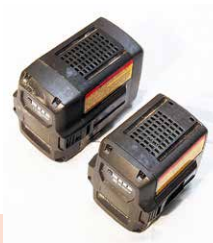
Akku irttoa painamalla akun sivuilla sijaitsevia klipsejä, jonka jälkeen akun voi vetää irti.
