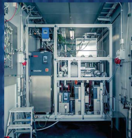
Liikuteltava tuotantolaitos, jossa hiilidioksi- dista ja vedystä valmistetaan sähkön avulla polttoaineita.
