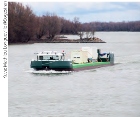
Pariisissa Seine-joella liikennöivä Zulu06 ei ole mikä tahansa proomu – se alkaa liikennöidä vielä tänä vuonna vedyn ja polttokenojen avulla.
